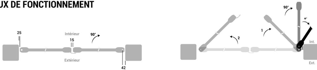
Le jeu de 25 mm est prévu pour éviter les coincements de doigt entre le pilier et le montant du portail lors de l'ouverture du portail. Un montage avec un jeu inférieur à 25mm n'est pas recommandé et la responsabilité du fabricant ne pourra être engagée en cas d'accident.
