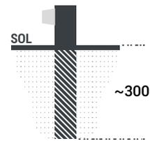
Les arrêt-ouverts simple ou à bascule sont fournis avec des tubes de 40x40 à sceller.
