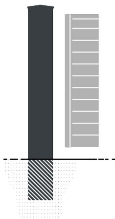
**!** L'aluminium ne doit pas rentrer en contact direct avec le ciment ou autre produit corrosif.
