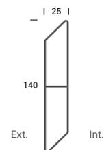
Les portails de la gamme OCCULTALU sont composés de lames de forme trapézoïdale et de montants, en aluminium extrudé. Ils sont vissés ensemble, avant la pose des clips en aluminium qui ne laisse aucune vis apparente.
