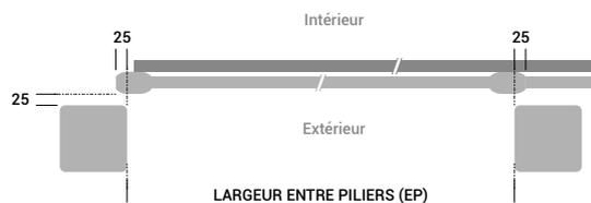
Le jeu de 25 mm, entre le pilier et le portail, est prévu pour éviter les coincements de doigt entre le pilier et le montant du portail lors de l'ouverture du portail. Un montage avec un jeu inférieur à 25mm n'est pas recommandé et la responsabilité du fabricant ne pourra être engagée en cas d'accident.
